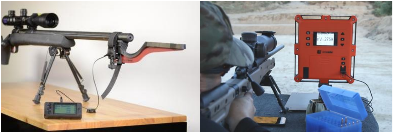
圖十三 槍口電磁式 (MagnetoSpeed) 與雷達波偵測式 (LabRadar) 測速儀 資料來源： http://www.3gsports.de 〈MagnetoSpeed V3 Chronograph〉及 http://www.ocabj.net 〈LabRadar Chronograph Review〉(檢索日期 2021 年 9 月 16 日)
