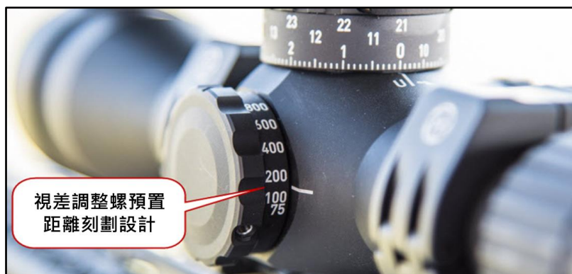
圖十七 視差調整螺與距離刻劃
